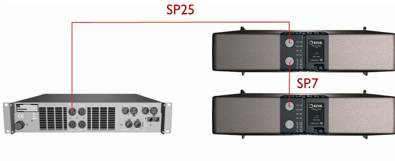
Figure 3 : Raccordement au contrôleur amplifié LA4 de deux enceintes KIVA en parallèle
