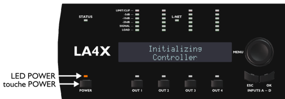
Figure 11 : Séquence de démarrage
